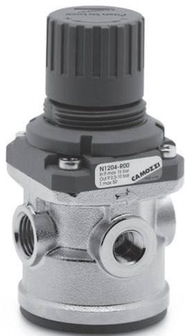
Регуляторы давления Серии N поставляются с соединительными размерами G1/4 и G1/8 и имеют резьбовое отверстие для присоединения манометра. Эти компактные регуляторы могут монтироваться на трубопроводах или на панели.
