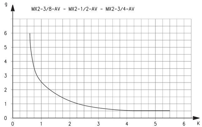
Константа К на графике показывает количество оборотов регулировочного винта для достижения требуемого времени нагнетания при входном давлении 6 бар. А = 5 оборотов, В = 4 оборотов, С = 3 оборотов, D = 2 оборотов, Е = 1 оборотов. Разброс значений входного давления может вызвать изменение времени нагнетания на  $\pm 20\%$ .
